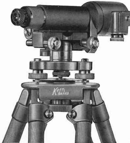
Präzisionsnivellier mit Mikrometer
