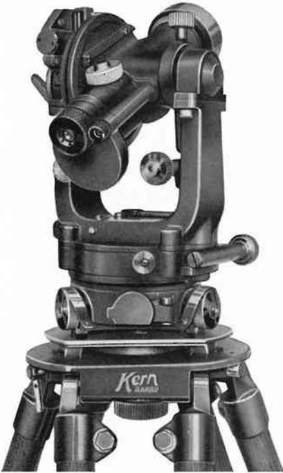
DKR - Reduktions-Tachymeter-Theodolit
