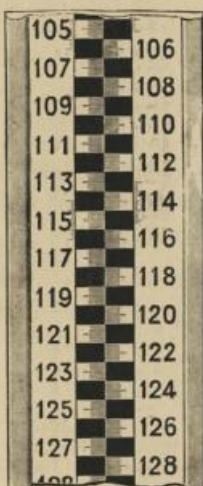
Aspetto di una biffa di precisione.
