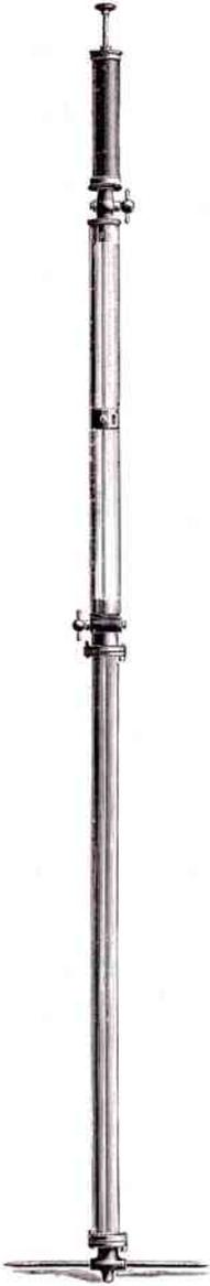
Dieses Instrument dient ebenfalls zum Messen der Wassergeschwindigkeit; sie besteht der Hauptsache nach aus zwei nebeneinander liegenden, oben miteinander verbundenen Röhren, die unten offen stehen und im rechten Winkel so abgebogen sind, dass die beiden Oeffnungen (feine Düsen) von einander abstehen.
