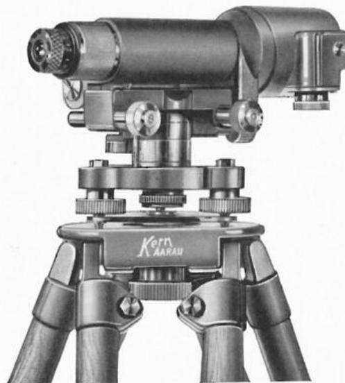
Präzisionsnivellier mit Mikrometer
